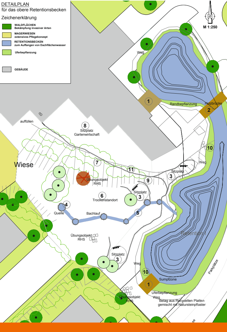
Plan des naturnah gestalteten Retentionsbeckens im Norden des Geländes
